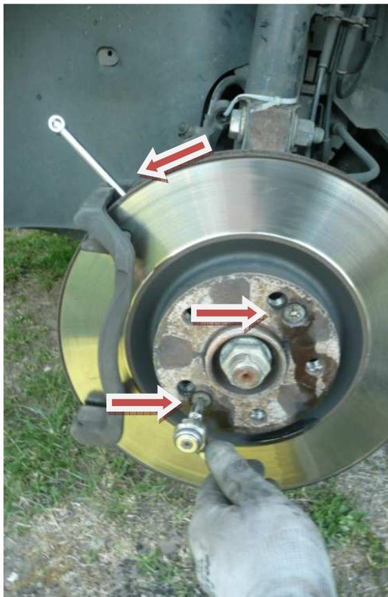
5) Démonter le support étrier en dévissant les deux grosses vis de derrière.
