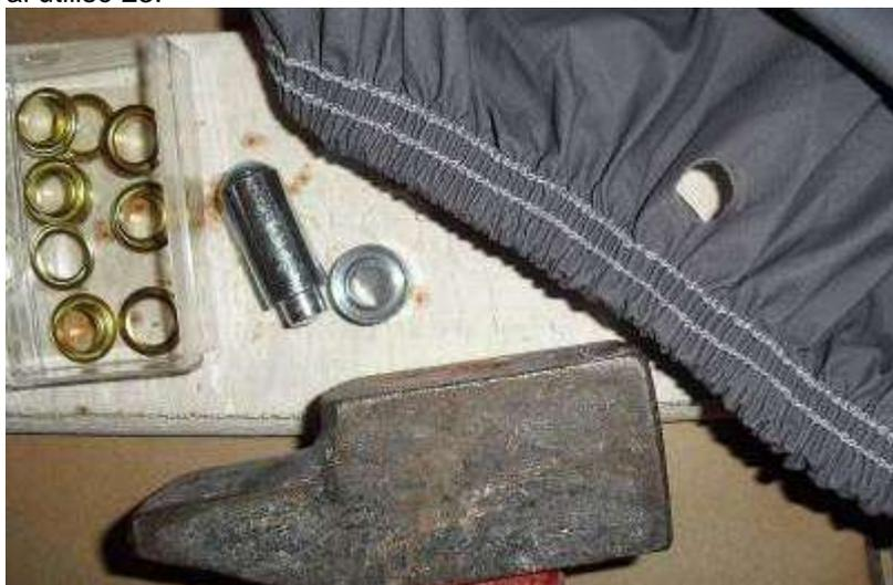
Percer la bâche à l'aide de l'outil et du marteau (un coup sec). Si le trou n'est pas totalement formé, ce n'est pas plus mal, car la bâche est fine et a tendance à percer trop large par rapport au diamètre de l'œillet : mon premier œillet n'avait pas emprisonné la toile sur tout le périmètre ; le risque est que la toile se déchire autour de l'œillet.
