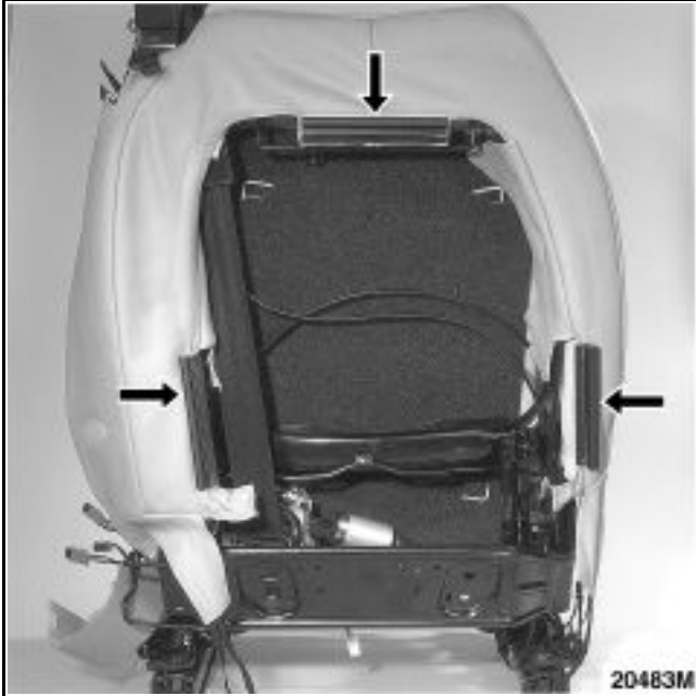
Déposer l'ensemble "housse - mousse de dossier".
