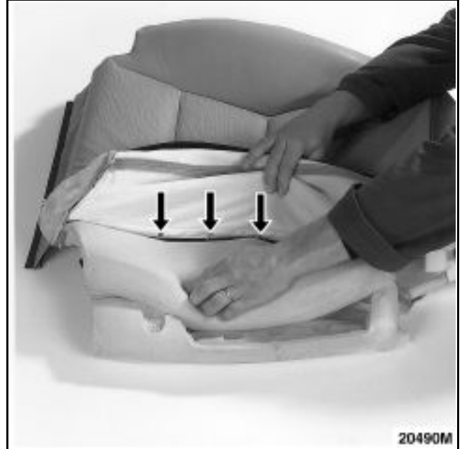
Retourner la coiffe de dossier et dégrafer les rappels de couture horizontaux.
