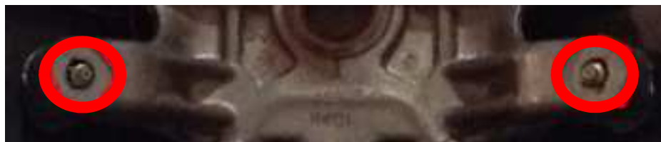
Vue des deux vis Airbag volant de face
