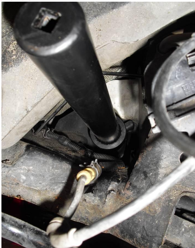
A gauche : outil en place ; à droite, rotule axiale intérieure déposée...
