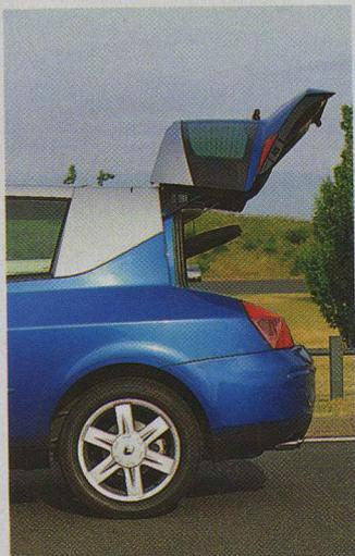
■ Impressionnant ce coffre doté d'une grande vitre bombée. La commande d'ouverture est électrique et le seuil de chargement haut (82 cm).
