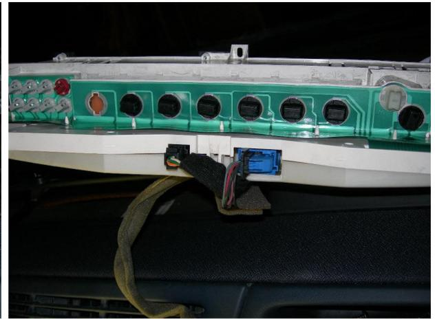
Type d'ampoule 1,3W : (elle est éteinte, c'est le reflet du flash) et le capteur d'ensoleillement (non je n'ai pas de gros doigts, c'est tout petit un capteur)
