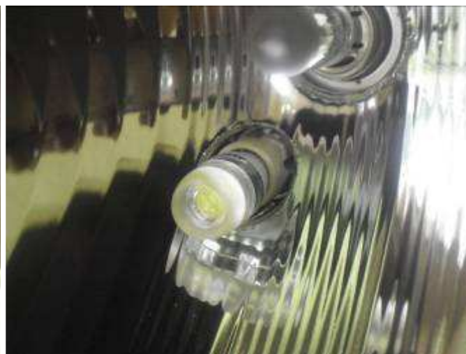
A gauche une ampoule ; à droite, la LED
