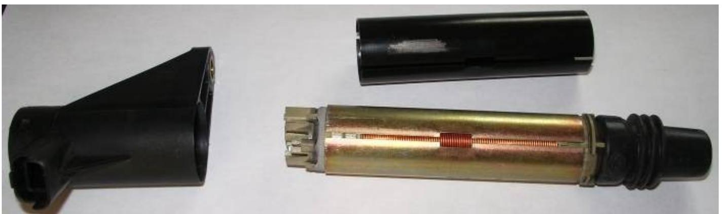
Et on remonte sans le tube noir (voire sans le deuxième tube mais dans ce cas prévoir une protection du bobinage qui n'empêche pas son refroidissement). Et ça doit fonctionner.
