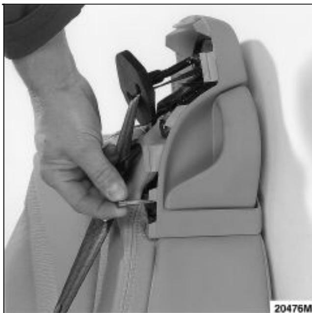
Déposer les trois vis de fixation de la coque arrière du carter de poutre.
