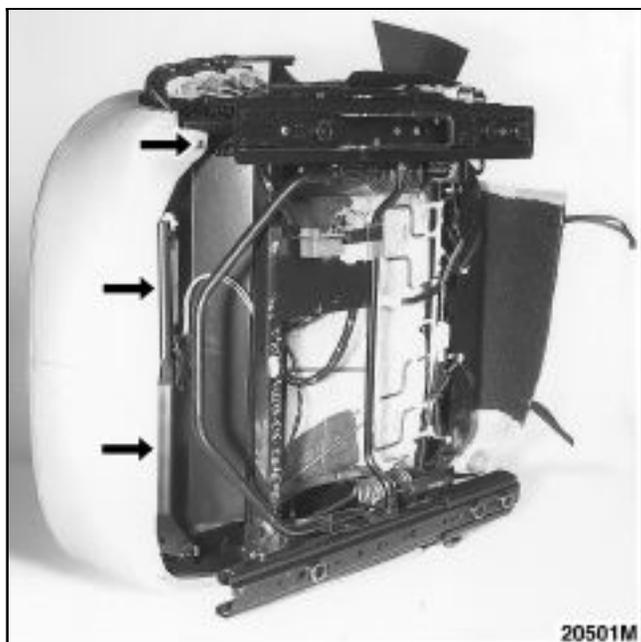
Déposer le profil de maintien gauche.
