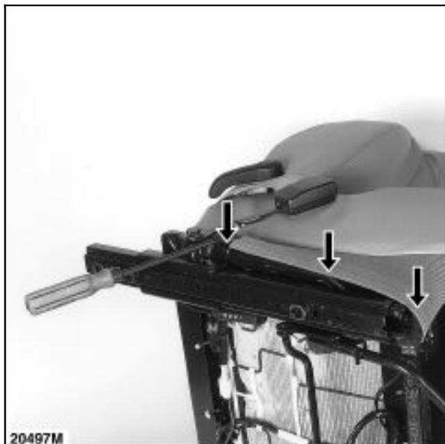
Déposer le profil de maintien droit côté pédoncule.
