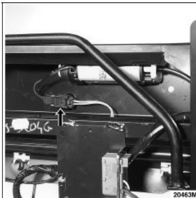
Percer les quatre rivets de fixation du moteur.
