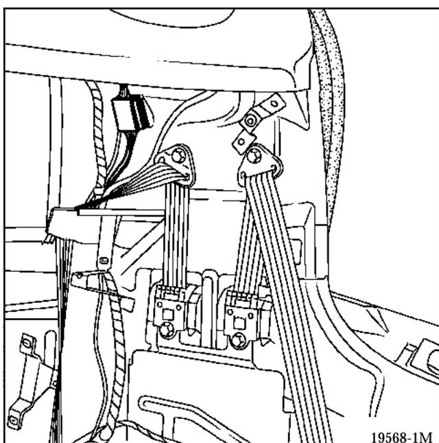
Déclipser le cache et débrancher le connecteur du rétroviseur et du capteur de pluie (si véhicule équipé).
