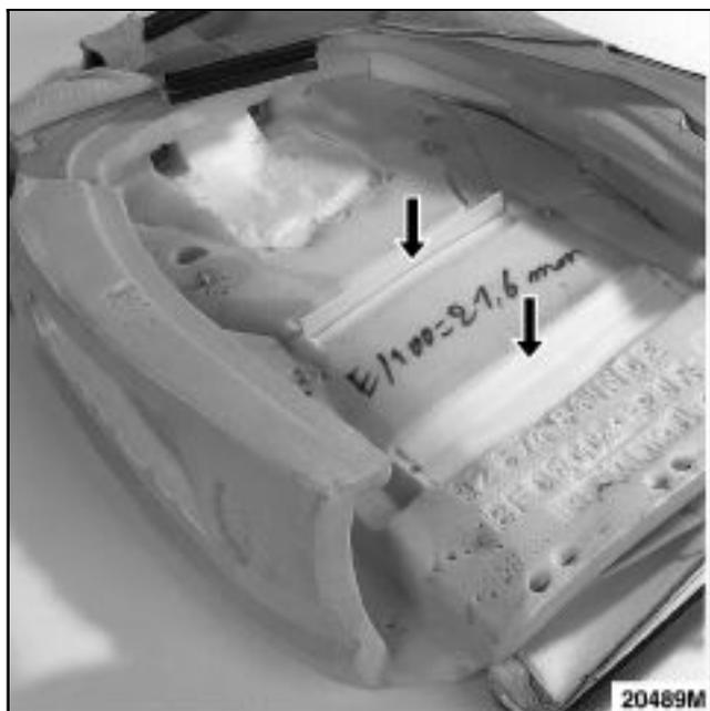
En cas de nécessité de remplacement de la nappe chauffante lombaire, il est impératif de remplacer également la mousse.
