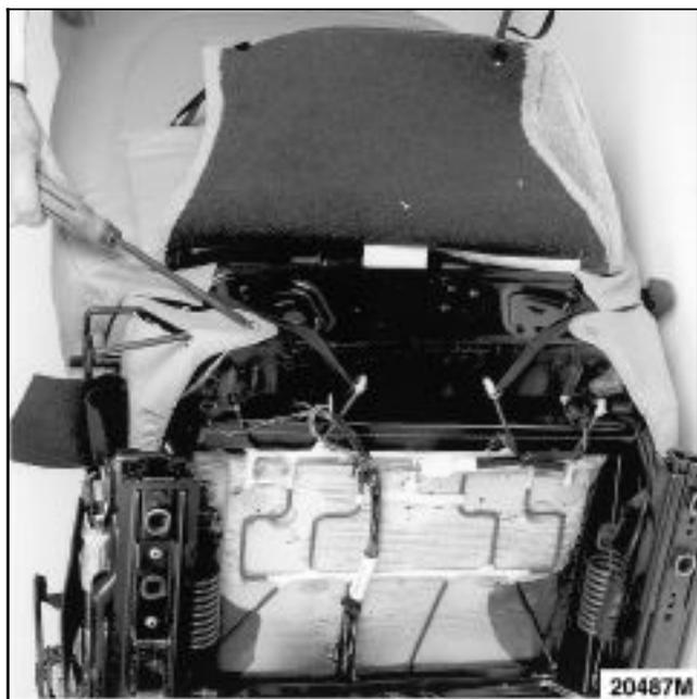
Déclipser les profils de maintien ainsi que les oreilles avant.
