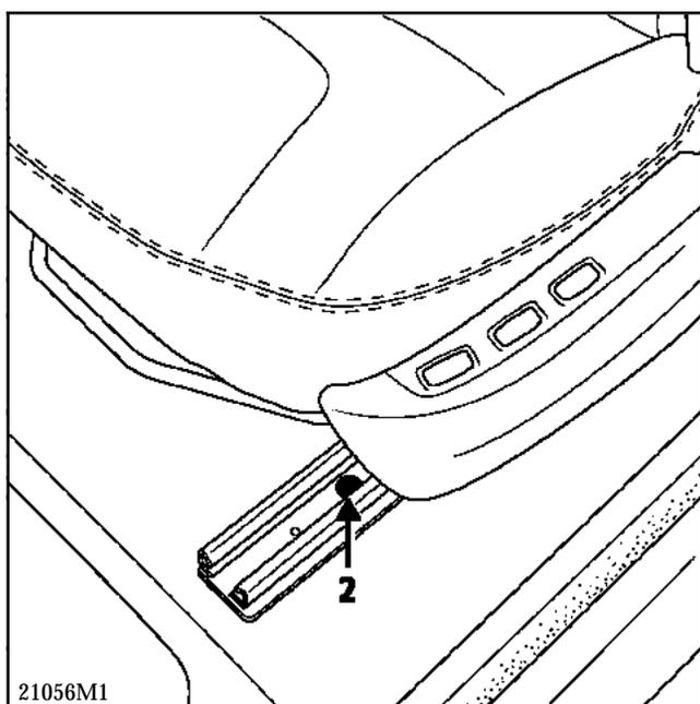
Avancer le siège au maximum et dévisser les trois fixations arrière de glissière.
