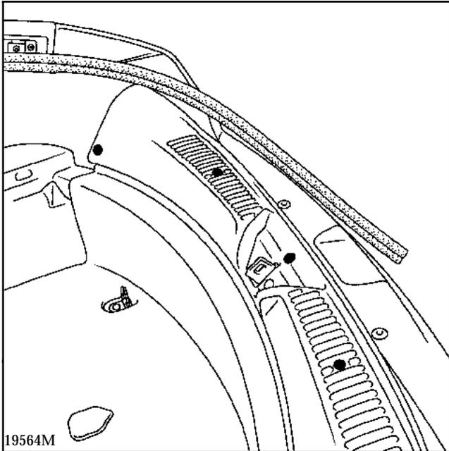
Déposer les quatre vis de fixation des anneaux d'arrimage (Étoile de 30).
