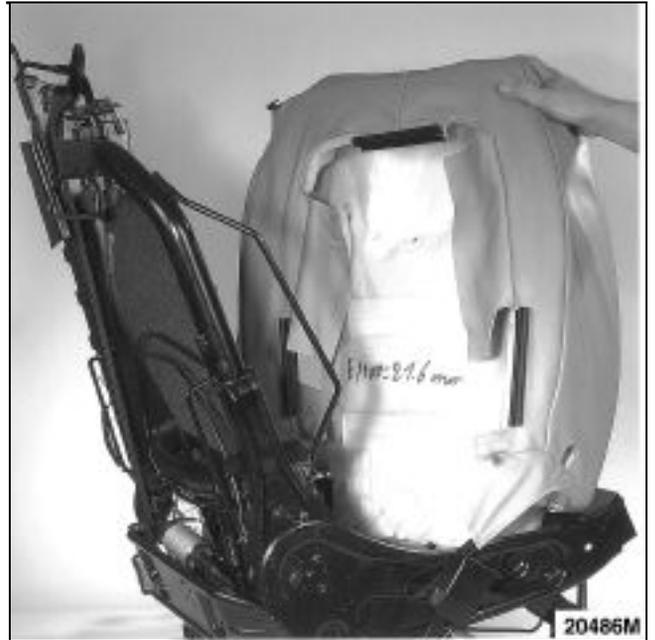
Déclipser les profils de maintien de housse.
