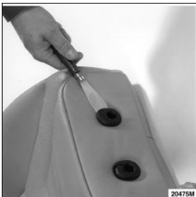
Déclipser les pattes de maintien de l'airbag latéral et l'oreille de maintien de housse de dossier.
