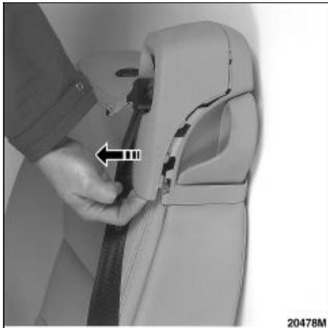
Sortir l'axe de la poignée de basculement de siège.
