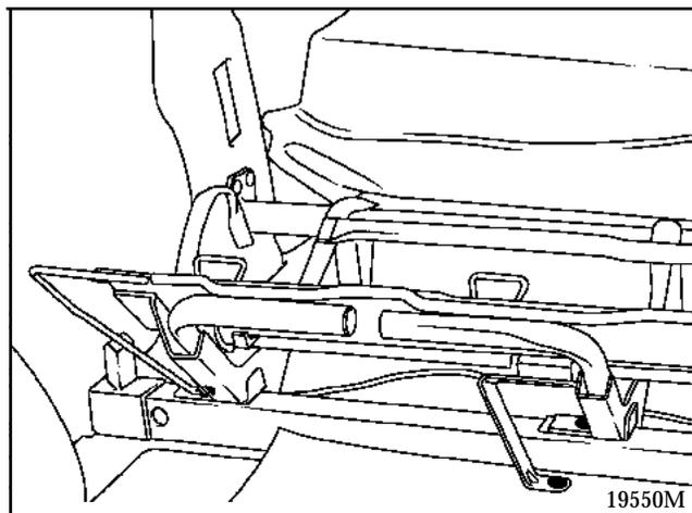
Déposer les quatre vis de fixation arrière.
