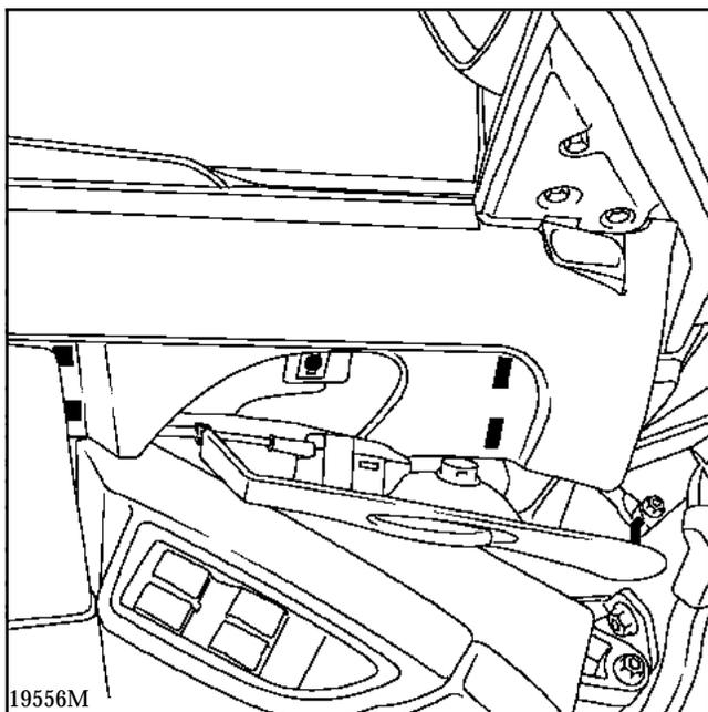
Déposer les quatre vis de fixation inférieure.
