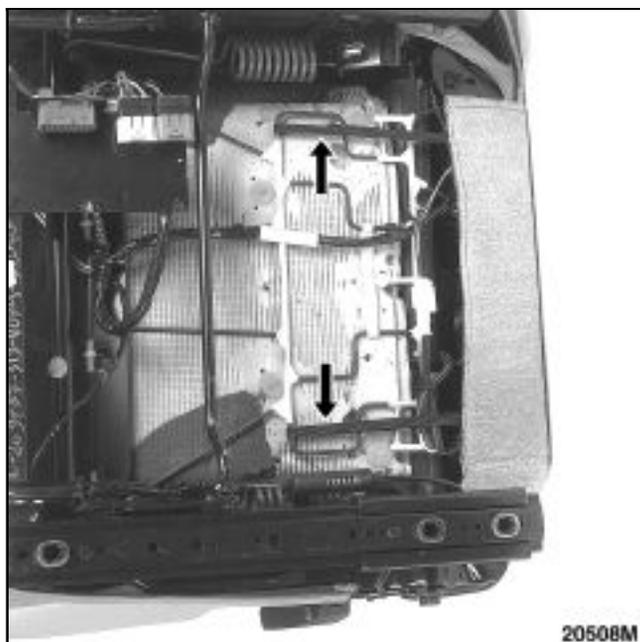
Déposer la poignée de réglage d'inclinaison de dossier par l'intérieur en écartant les fentes de la poignée avec un tournevis, puis la tirer vers le haut.
