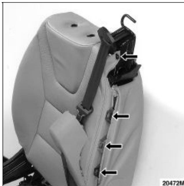
Déclipser les clips de maintien de la housse de dossier en les tirant vers l'extérieur de siège.
