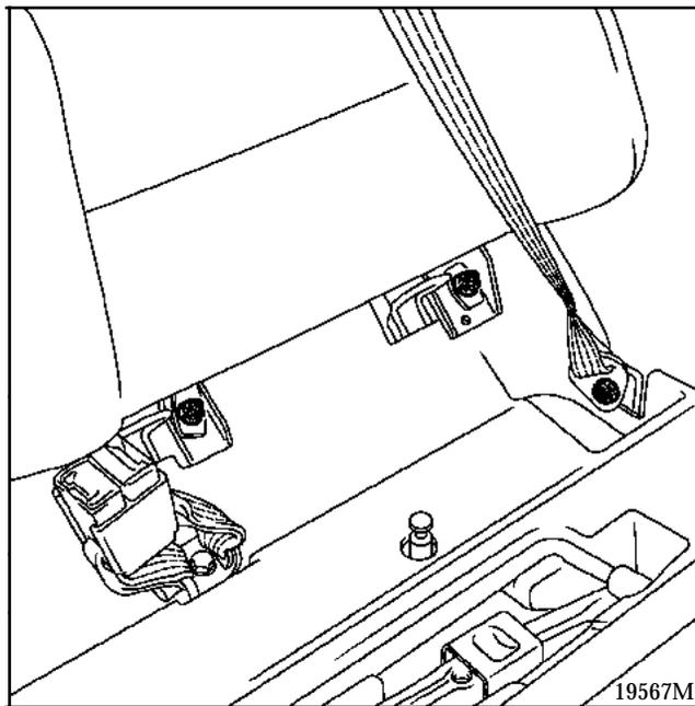
Basculer les assises de siège et déposer les quatre écrous de fixation du dossier.
