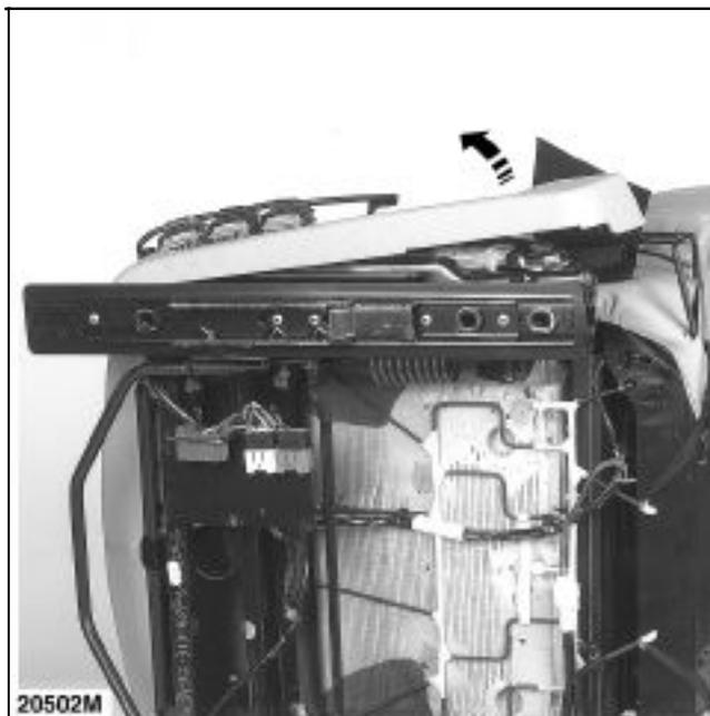
Déposer les deux agrafes de maintien de garnissage.
