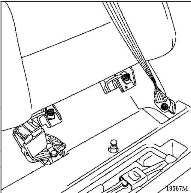
Basculer les assises et déposer les quatre écrous de fixation du dossier.
