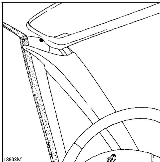
Sortir le garnissage en le poussant vers le haut sous le garnissage de pavillon.
