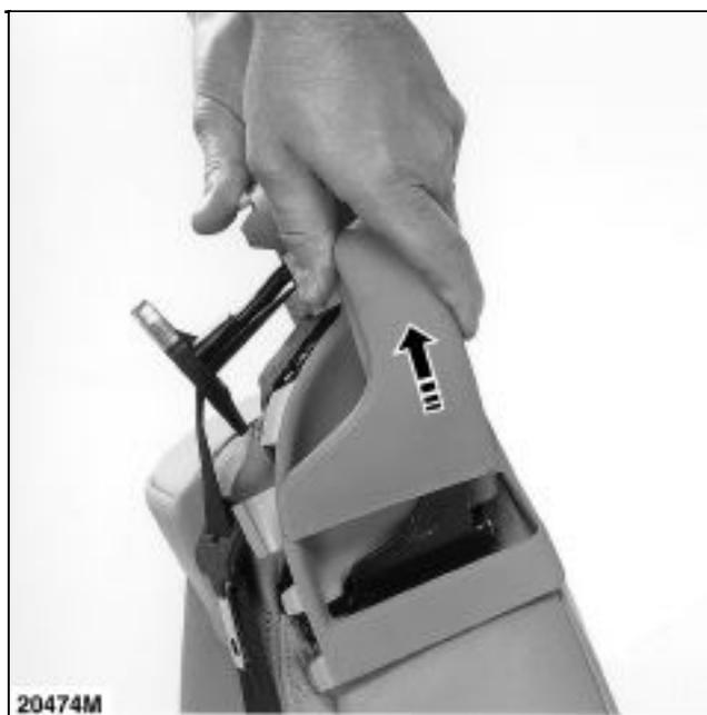
Déposer la coque arrière de carter de poutre.
