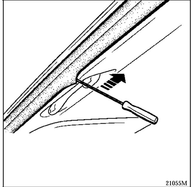
Remettre les joints en place à l'aide d'un tournevis fin.
