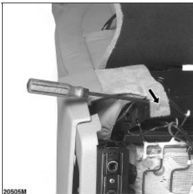
Déposer la vis de fixation du carter.
