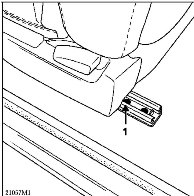
Débrancher les prétensionneurs et l'alimentation du siège électrique.
