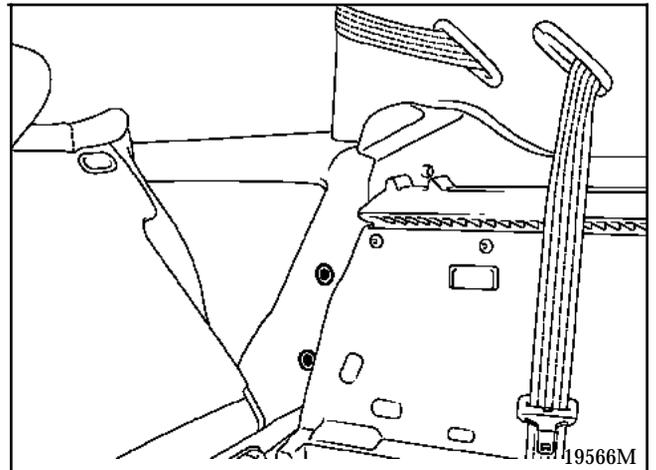
Tirer la partie avant du panneau légèrement vers l'intérieur du véhicule, pour le sortir des joints de recouvrement et dégrafer les deux clips.
