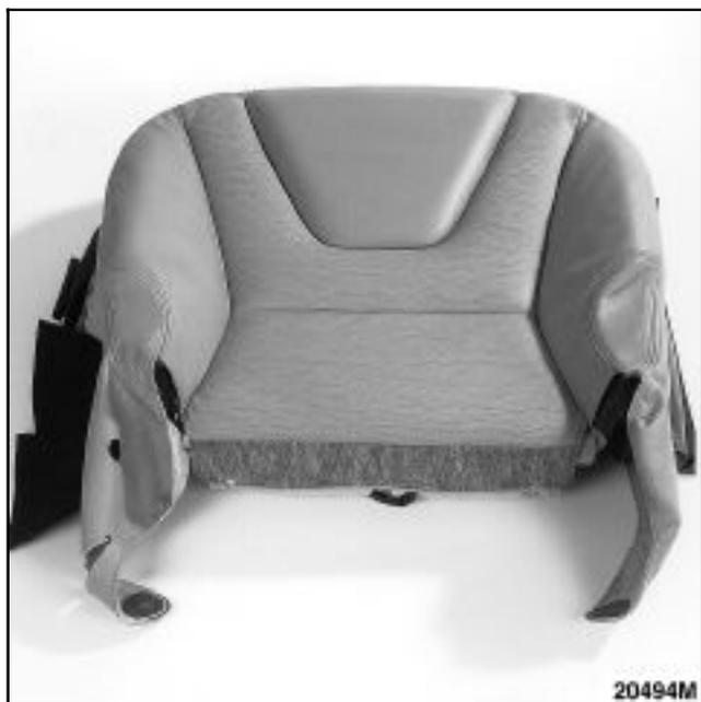
En cas de nécessité de remplacement de la nappe chauffante, il est impératif de remplacer également la mousse.
