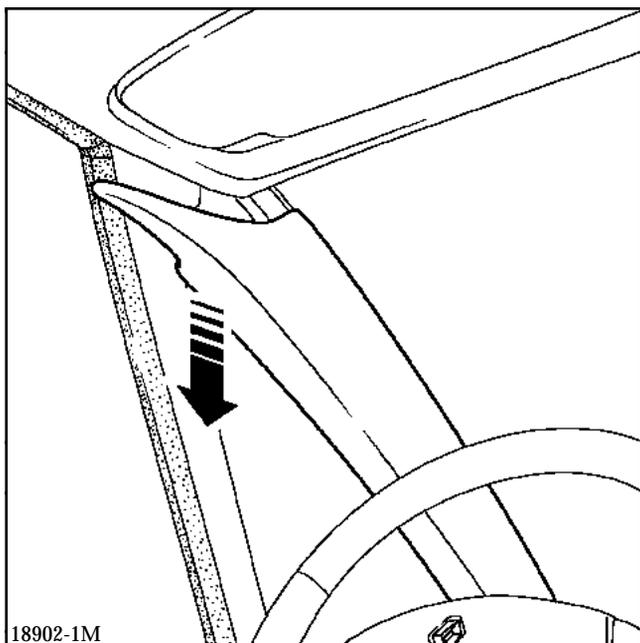
Débrancher le connecteur du faisceau de pavillon.
