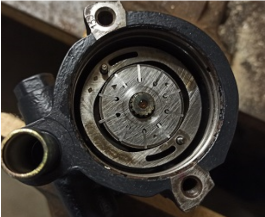
24. Mise en place du circlips
