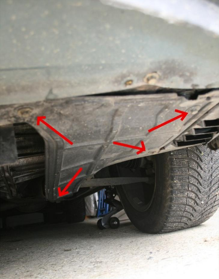
(photo ci contre) Démontage de la plaque de protection sous moteur AVG (4 vis de 10)
