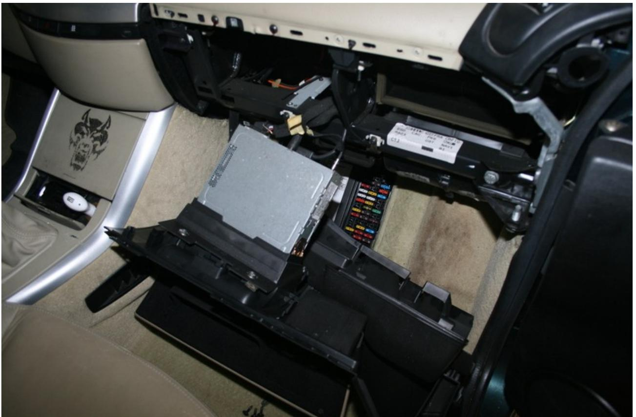
5 - Débrancher 5 prises (si GPS) : éclairage de sol, haut parleur, deux prises GPS et antenne GPS.
