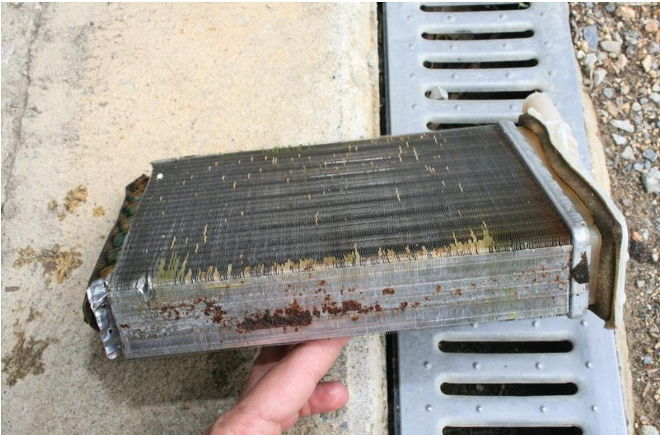
Une fois le radiateur sorti il faut penser à vider son compartiment qui doit être plein de liquide de refroidissement. Pour cela, 3 vis sont accessibles puis on fait levier pour écarter les deux parties du carter et le vider sur un chiffon absorbant...
