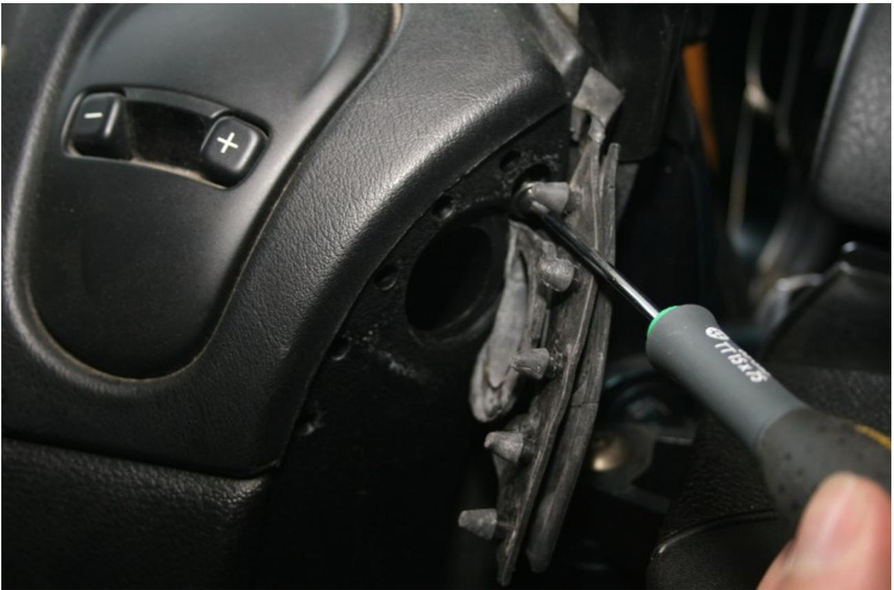
Le bloc se détache alors. Attention de ne pas tirer trop, il y a des fils à débrancher.
