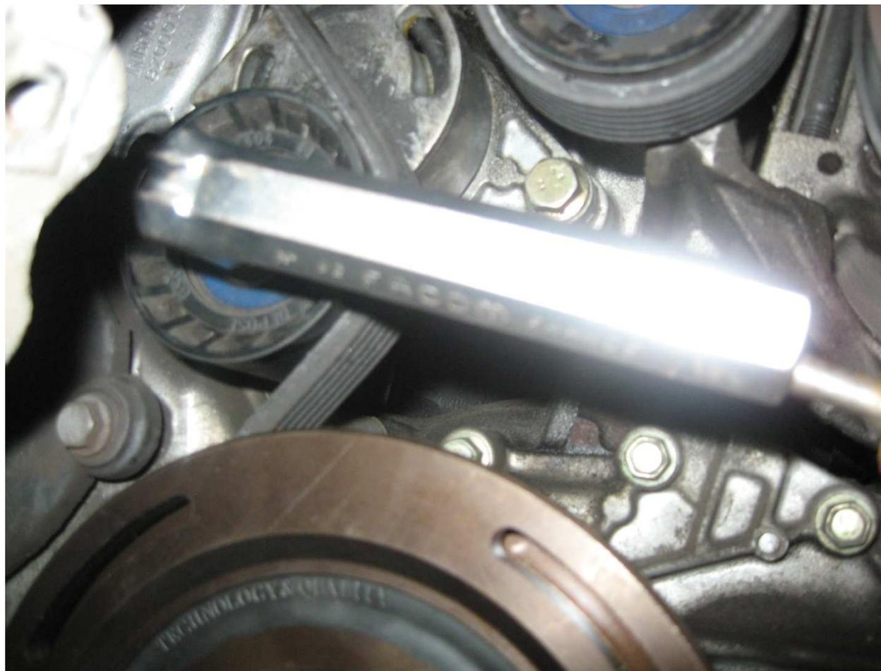
Mettre la courroie en place en oubliant une poulie du bas avec le galet tendeur en place , faire un effort de serrage sur la vis du galet , celui-ci se déplace (effort du ressort à vaincre) et déplacez celui-ci avec la clef, il ne reste plus qu'à mettre la courroie sur la dernière poulie et vous lâchez tout.
